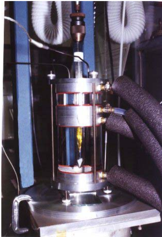
Gambar 9.5 Foto alat penumbuh kristal teknik Bridgman.
