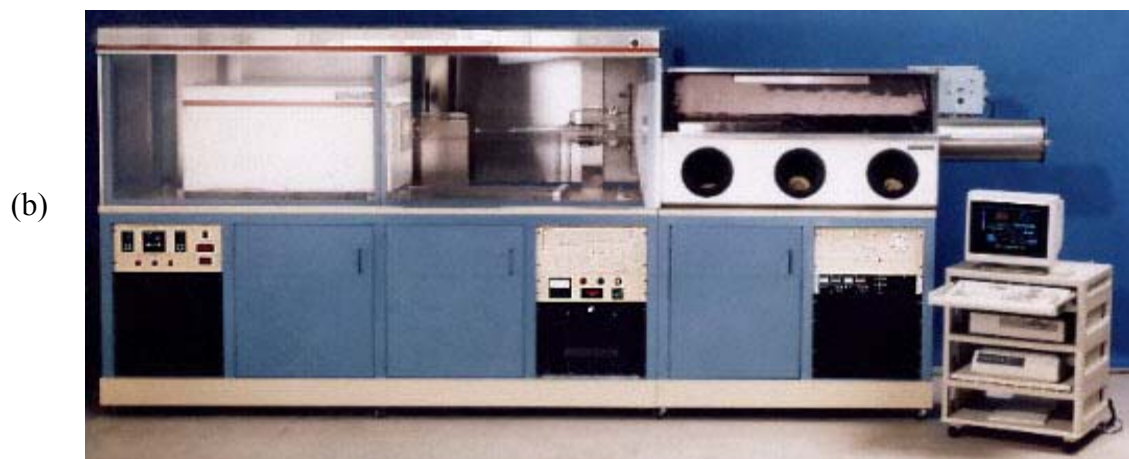
Gambar 9.10 Foto sistem LPE komersial untuk penumbuhan material semikonduktor multi-lapisan.
